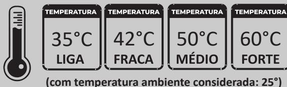
6. Para alterar a temperatura, basta pressionar e soltar o botão TEMP, o LED mudará de posição informando a nova temperatura, conforme figura.
