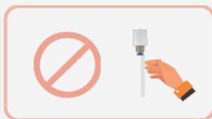
Não puxe a mangueira sem destravar o conector de engate rápido. Esta ação pode danificar a mangueira e prejudicar a sucção do equipamento.
